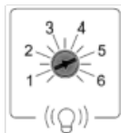
Bild 4: Einstellregler für Helligkeit des Findelichts
